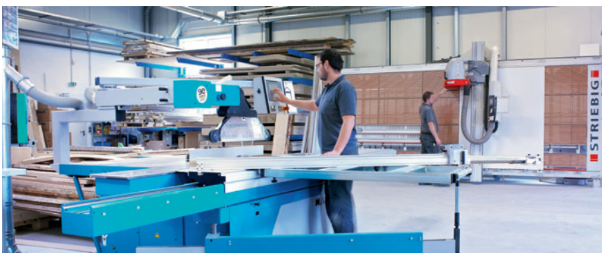
Blick in den Zuschnittbereich mit Format- und Plattensäge
