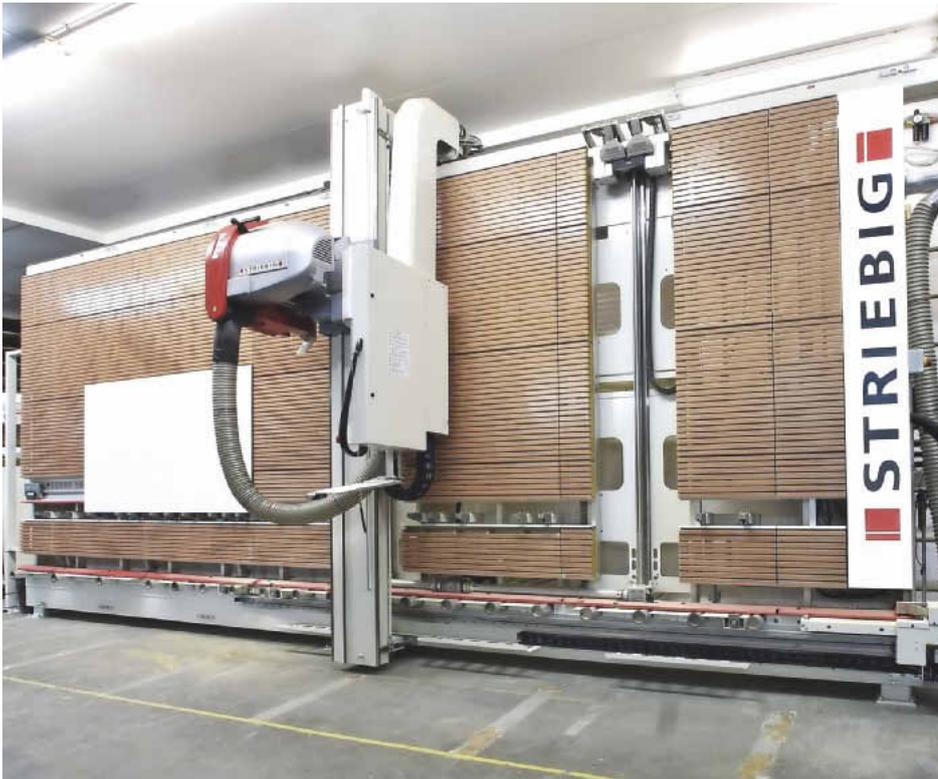
*Die Striebig 4D hat einen Schnittbereich von 5300 x 2240 mm und als Optionen z. B. programmierbarer Plattenschieber, Plattenabsenkvorrichtung, Plattenoptimierung und automatische Sägebalkenpositionierung.*
